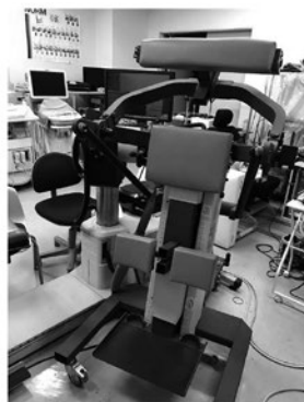
写真1 等速性筋力測定装置 (CYBEX 770 Norm システム) に Trunk Extension/Flexion Unit (TEF) を接続
